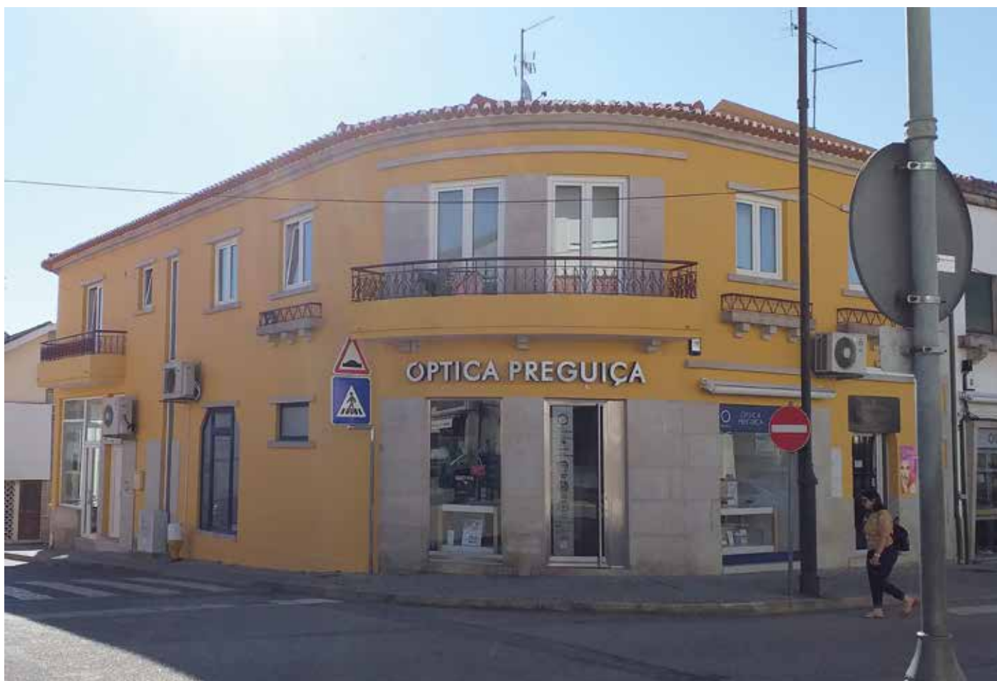
↑ Obra: Óptica Preguiça // Localidade: Valpaços // Produtos: Fachada: Primário Pliomil, Tinta Acrílica Pura 9G TD A354 Ocre Médio // Cliente: Franklin Oliveira Aplicador: José Junqueira // Comercial: Marco Cardoso
