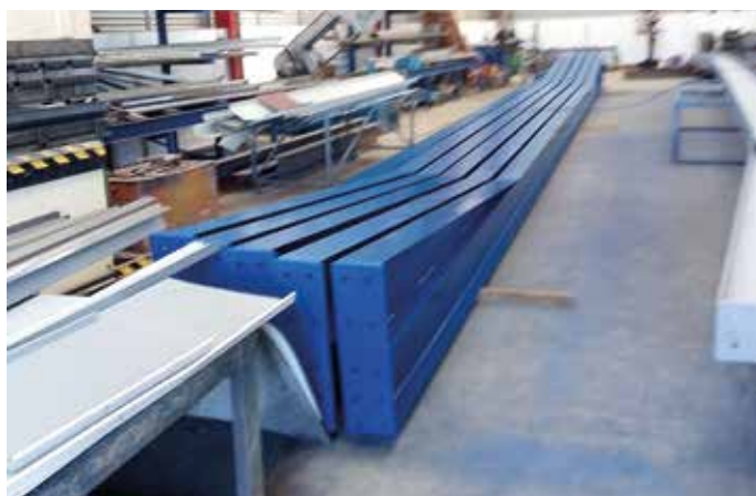
↑ Obra: Asnas de Ferro // Localidade: Estremoz // Produtos: Primário Anticorrosivo Cinzento, Esmalte SR RAL 5010 // Cliente: Luís Silva Batista // Comercial: Vitor Neto
