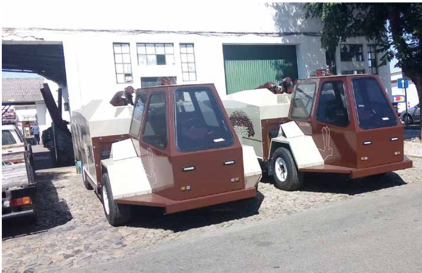
↑ Obra: Máquinas de descascar nozes // Localidade: Estremoz // Produtos: Primário Anticorrosivo Cinzento, Esmalte PU Brilhante Cinzento // Cliente: Pirra Comercial // Vitor Neto
